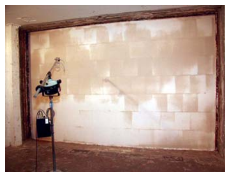
Fig. 3 L'enduit peut améliorer les performances acoustiques, surtout dans le cas de blocs poreux.
