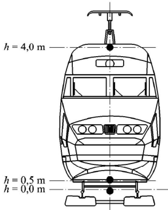
**Figure 1 – Position des sources acoustiques équivalentes pour le ferroviaire**
