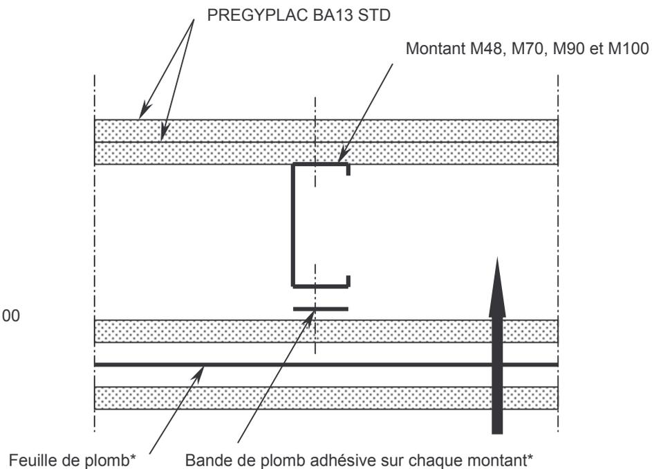
\*utilisation de bande adhésive en plomb pour éviter le recouvrement systématique à la jonction des feuilles aux épaisseurs importantes qui risquent de créer une surépaisseur contrariant les niveaux de planimétrie
