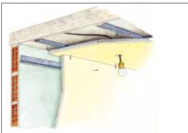
Traitement d'une pièce avec Placosilence® (mur et plafond).
