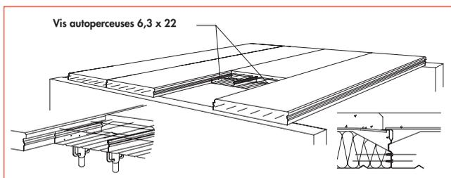
Le transfert des charges amenées par l'élément donnant sur la trémie est assuré par le « couturage » des profilés suivant le croquis ci-contre . vis autoforeuses 6,3x22.
