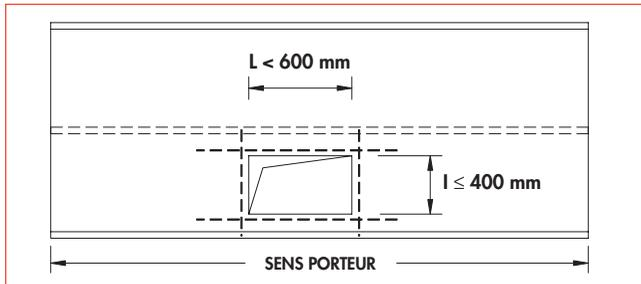
Les réservations sont généralement réalisées avant la préfabrication des éléments.
