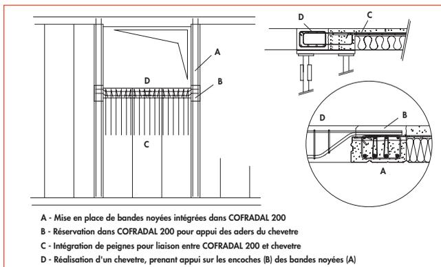
Les trémies supérieures à 120 cm font l'objet d'un chevêtre traditionnel en béton armé.
