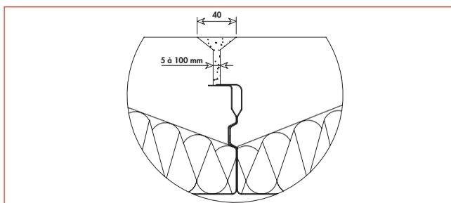
La consistance du mortier doit faciliter la mise en place du mortier et permettre un plein remplissage du joint (consommation moyenne : 0,8 Kg/m<sup>2</sup> de plancher)
