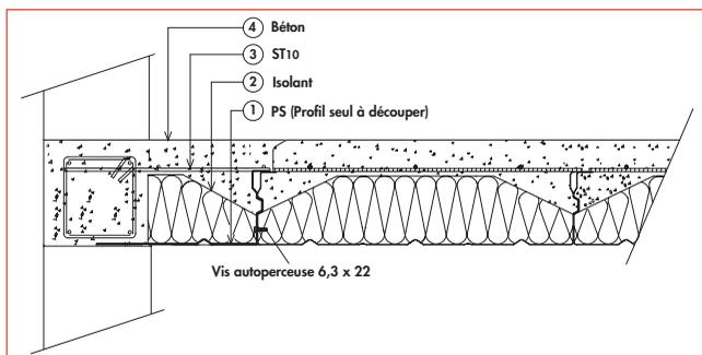
Les éléments de plancher COFRADAL 200 ont une largeur standard de 1200 mm ou 600 mm.
