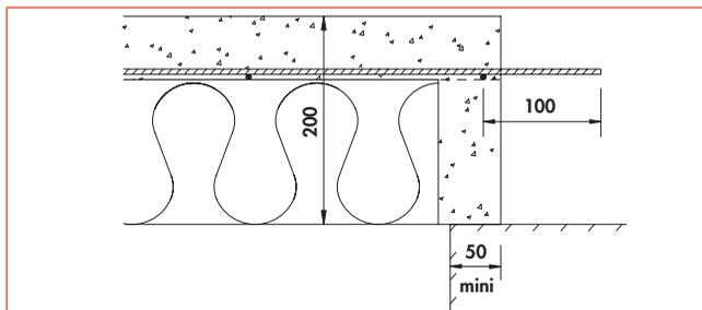
Le plancher COFRADAL 200 peut prendre appui sur tout type de structure.
