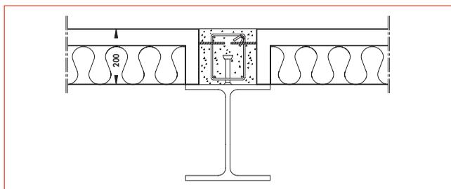
Il est recommandé que les éléments de plancher COFRADAL 200 soient reliés au niveau des appuis, à un ferrailage filant perpendiculaire au sens porteur du plancher. Les aciers du treillis soudé dépassant et les éventuels aciers de renfort feu se retrouvent de sorte ancrés dans un "nœud" assurant ainsi une parfaite liaison entre le plancher et ses appuis.
