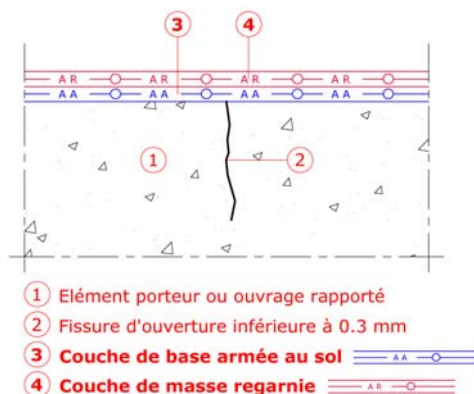
Schéma 4 - Traitement des fissures d'ouverture \leq 0,3 mm
