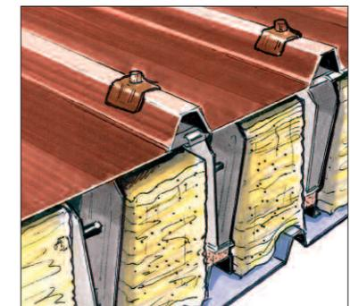
Pose de l'isolant et de la couverture finale.
