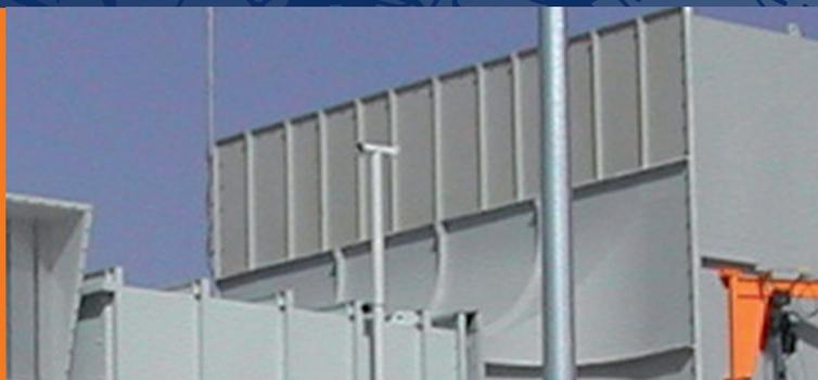
Hipertec Roof Sound est un panneau sandwich métallique autoportant avec une isolation en laine de roche de haute densité. Sa face intérieure perforée lui permet d'améliorer l'isolation et l'absorption acoustiques des locaux dans lesquels il est utilisé.
