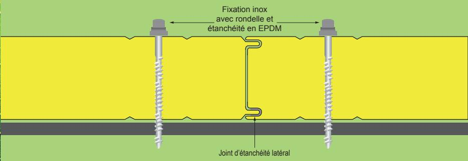
Metfiber Eco Wall est un panneau sandwich métallique autoportant avec une isolation en laine de verre. C'est un produit écologique puisque sa fabrication est réalisée avec 80% de laine de verre recyclée ce qui a un impact positif sur la préservation des ressources naturelles. Par ailleurs, il est incombustible et particulièrement adapté dans les locaux où une isolation acoustique est exigée tout en bénéficiant d'une résistance au feu.
