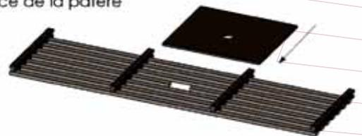
8 Fixation de la patère et maintien des lames par vissage
