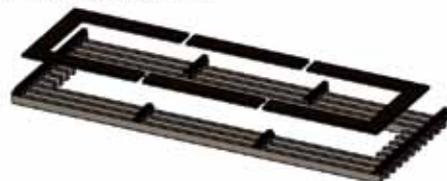
8 Fixation des patères et maintien des lames par vissage
