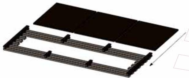
6 Fixation des patères et maintien des lames par vissage
