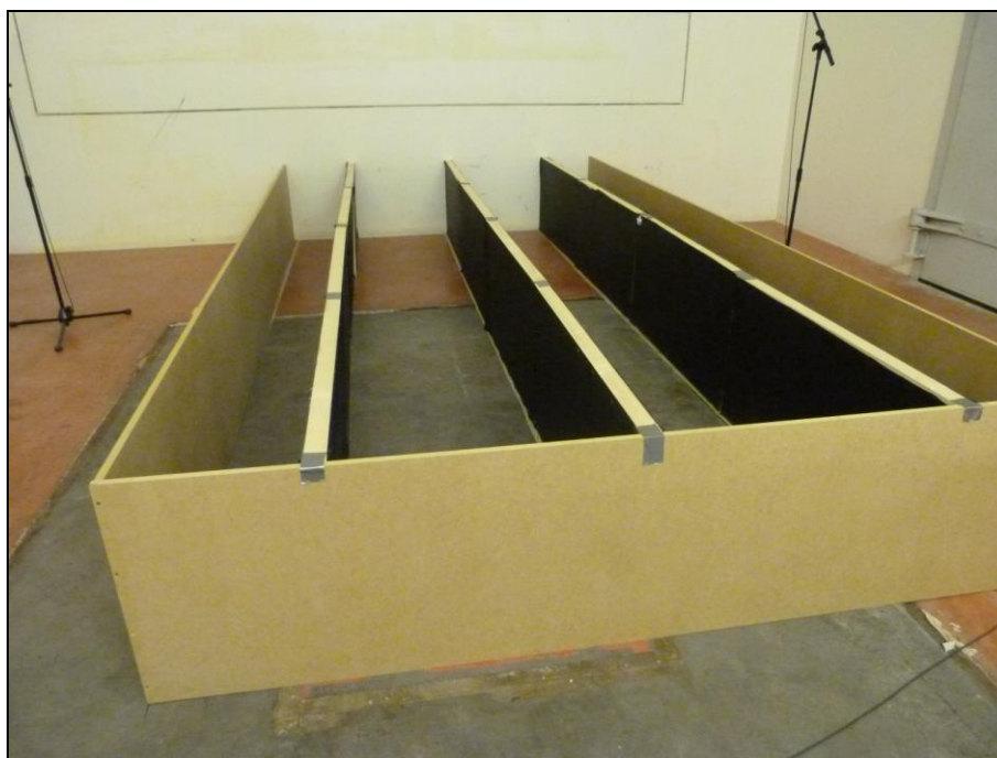
Photo 1 : Mesure d'un ensemble de baffles en salle réverbérante
