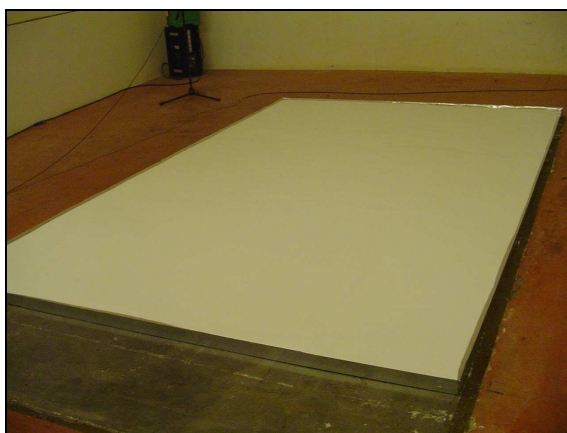
Photo 1 : Mesure de la toile BATYLINE ® Aw en association avec la laine de roche Rockmur
