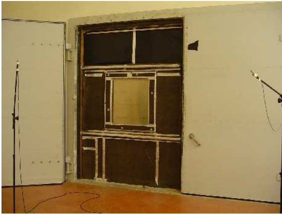
Photo 1 : Baie de mesure coté salle réverbérante
