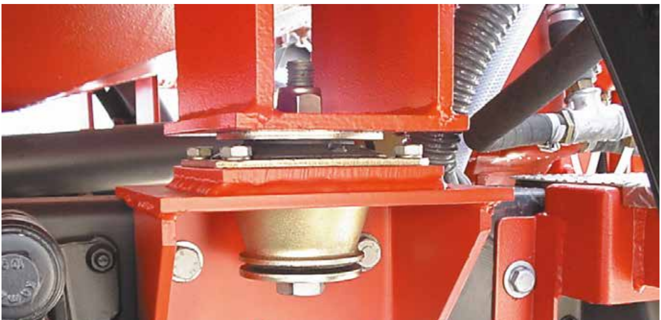
Rondelle Supérieure Cône 121 code 606378 Rondelle Inférieure Cône 121 code 606379
