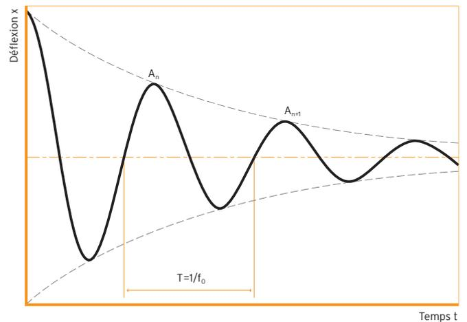
Fig. 9 : Comportement du déclin d'une vibration libre
