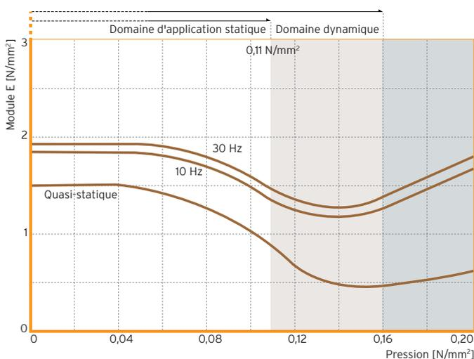
Fig. 3 : Evolution en fonction de la charge du module E statique et dynamique (exemple Sylomer® SR 110)
