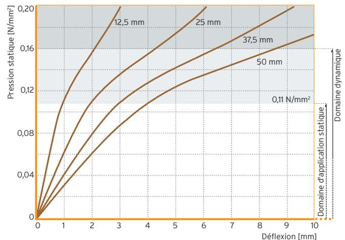
Fig. 2 : Courbes de déflexion (exemple Sylomer® SR 110)
