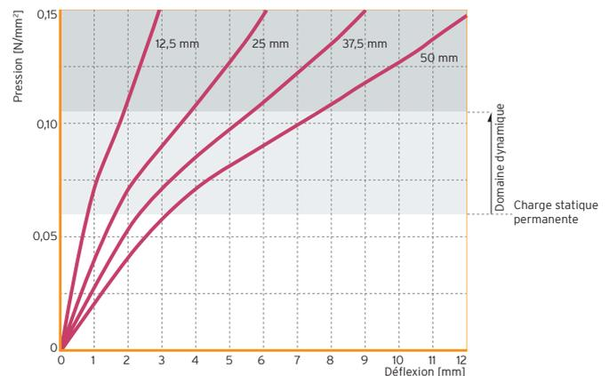
Courbe de déflexion quasi-statique avec une vitesse de déformation de 1 % de l'épaisseur par seconde ; essai effectué entre des plaques d'acier planes ; enregistrement au bout du 3<sup>e</sup> cycle contrôle à température ambiante
