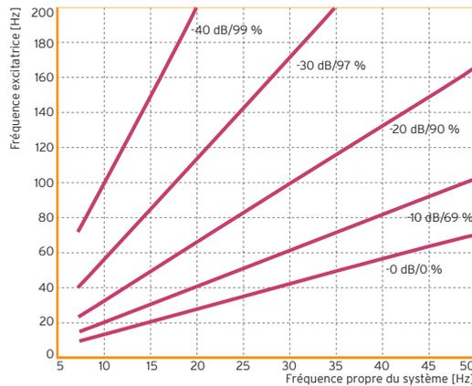
Réduction de la transmission des vibrations mécaniques à l'aide d'un appui élastique en Sylodyn® NB sur une structure rigide.
