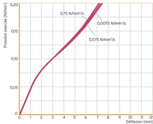
**Dépendance à l'amplitude :** précontrainte sous charge statique permanente ; facteur de forme ;  $q = 3$  ; épaisseur du matériau : 25 mm
