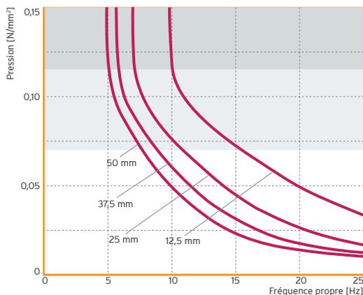
Le module d'élasticité statique est tangent à la courbe de déflexion. Le module d'élasticité dynamique est soumis à une excitation sinusoïdale à un niveau de vitesse de 100 dB v Re.  $5 \times 10^{-8}$  m/s ; mesure effectuée conformément à la norme DIN 53513
