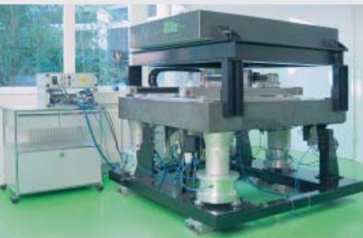
Un pot vibrant de 1600 Newtons (X-Y-Z) permet d'exciter nos systèmes antivibratoires sur une plage de fréquence de 0,5 à 300hz, donc de travailler dans les fréquences propres des isolateurs ainsi que sur les plages caractéristiques de structures et bâtiments.
