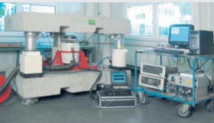
Banc d'essais vibratoires BILZ (1600 Newton X-Y-Z Shaker)
