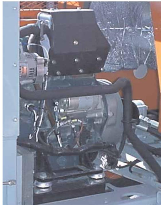
C'est un support idéal pour les moteurs où il est physiquement impossible d'installer des supports antivibratoires à la même hauteur que le vilebrequin.
