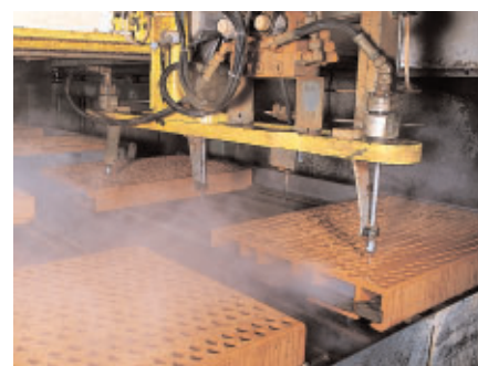
poste de perçage des bardages acoustiques
