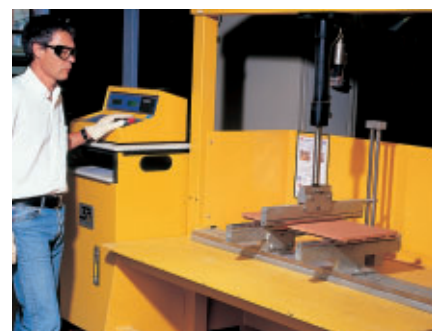
test de résistance à la flexion
