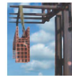
Suspentes pour manutention à l'élevateur ou à la grue (acier formant boucle suffisamment résistante - Ø10).
