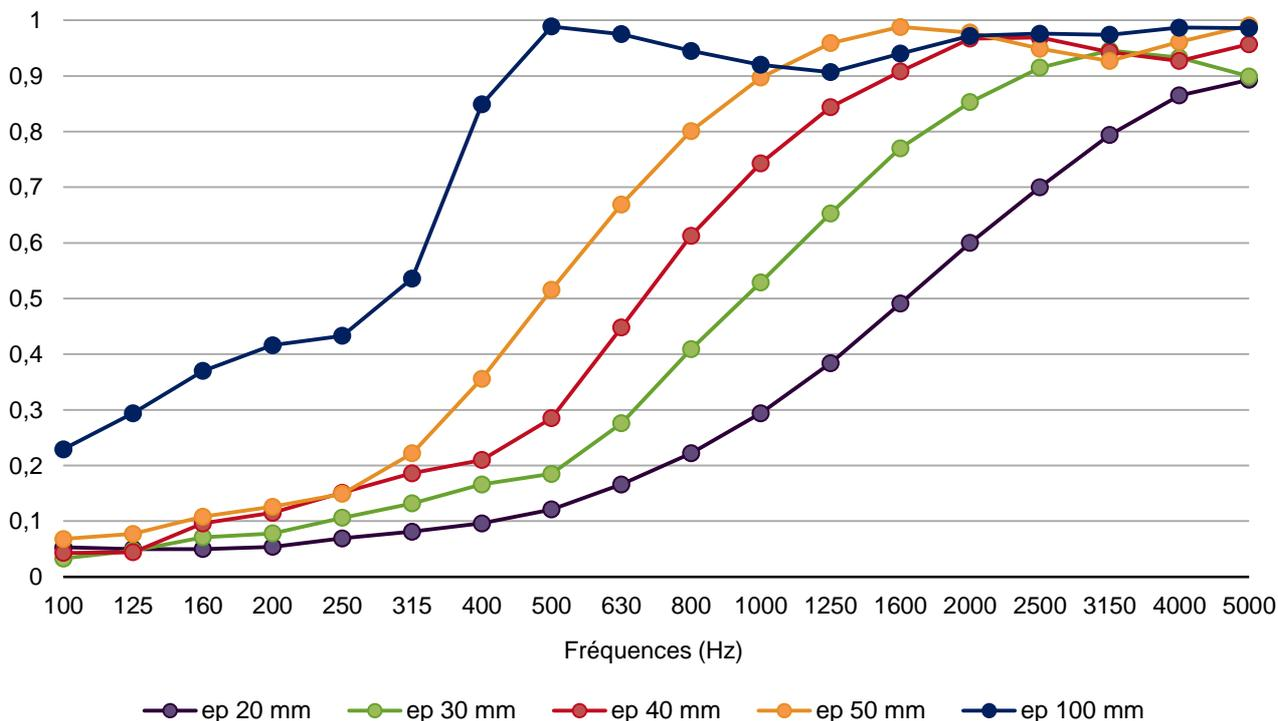
Indices d'absorption acoustique suivant ISO 354 (mesures en salle réverbérante)
