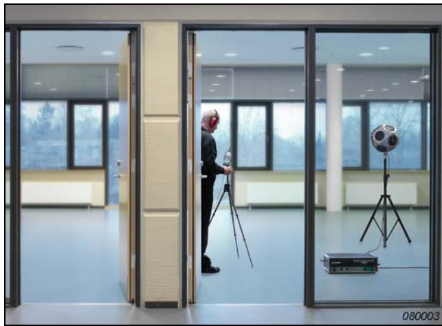
Fig. 7 Mesurage du Temps de réverbération par la méthode du Bruit interrompu
