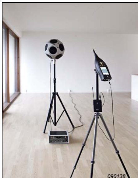
Fig. 21 Mesurage du Temps de réverbération au moyen d'un bruit stable interrompu
