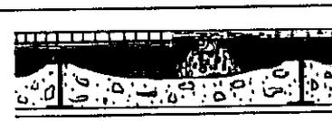
Parquet de 22 sur lambourdes scellées au plâtre<br>Fibre minérale en vrac<br>Augets plâtre et piâtras<br>Enduit plâtre de 20                                                    |
