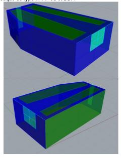
**Salle de formation musicale 2 :** En vert : 50 m² d'éléments de finition plâtre perforé participant à la correction acoustique de type FPPP ou et DBPP
