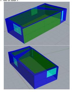
**Salle d'ensemble 2 :** En vert : 77 m² d'éléments de finition plâtre perforé participant à la correction acoustique de type FPPP ou et DBPP
