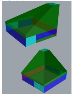
Salle de danse 2 : En vert : 210 m² d'éléments de finition plâtre perforé participant à la correction acoustique de type FPPP ou et DBPPDevant miroir : 27m² de rideaux de correction acoustique lourds 400g/m² plissés à 100% de plis installés à une distance de 15cm des parois, soit une surface totale installée de plus de 54m²
