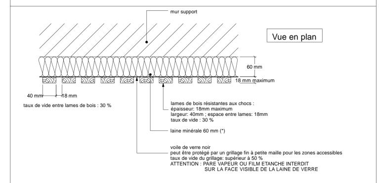
(\*): le matelas de laine minérale ne doit pas être comprimé. A cet effet son épaisseur sera inférieure ou égale à l'épaisseur des lambourdes. le matelas de laine minérale doit impérativement être plaqué contre les lames de bois. ( pas de lame d'air entre lames bois et matelas de laine minérale)
