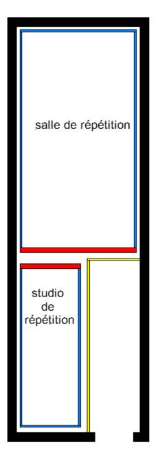
parement type P1 : 2 BA13 ossature indépendante de la structure fixée exclusivement à la dalle flottante
