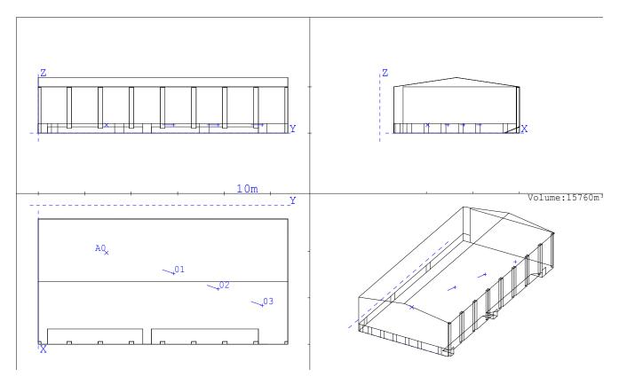
Pour le calcul du TR60, une source omnidirectionnelle A0 dans un angle de la salle opposé aux gradins.
