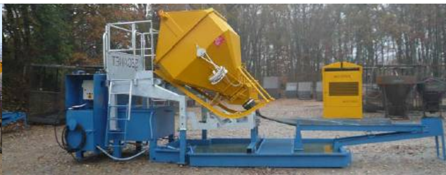
Exemple de système de traitement complet des laitances de béton
