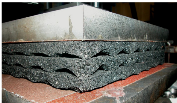
Exécution des essais de DAMTEC® vibra 3D à 3 couches et de DAMTEC® vibra soft à une couche.
