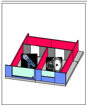
Séparatif : Cloison intérieure Cloison 98/48 av ec Im 45 mm Couloir : Refend Cloison 98/48 vide
