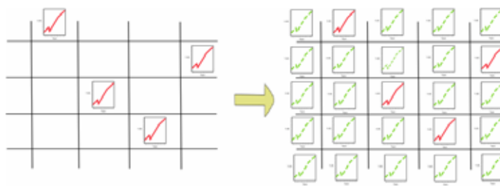
Figure 2 : Principe de la méthode d'extension de mesures : seuls certains produits sont mesurés (rouge), les autres sont déduits (vert).
