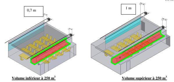
A noter pour les locaux d'un volume inférieur ou égal à 250 m<sup>3</sup>, si absence de grilles de transfert, les 2 bandes sans faux plafond de correction acoustique peuvent avoir une largeur équivalente de 0.75 m chacune.
