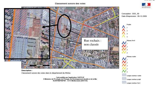
Au vu de l'Arrêté du 30 mai 1996, les isolements acoustiques des façades pour les locaux occupés (non compris cages d'escaliers, circulations ...)  $D_{nT,A,tr}$  sont donc de 30 dB mini.
