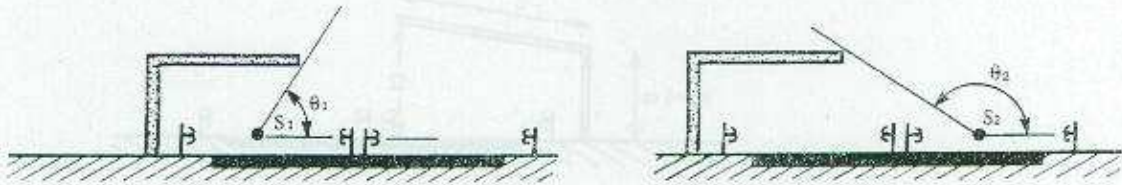
Schéma 4.120 : La route est ici décomposée en deux lignes de sources parallèles S_1 et S_2 . Les angles de rayonnement direct pour une couverture couvrant 1/2 chaussée sont ici figurés par les angles \theta_1 et \theta_2 respectivement pour les sources S_1 et S_2 .
