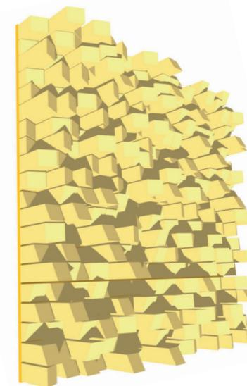
Pour absorber certaines fréquences et en réfléchir d'autres, des diffuseurs sélectifs par fréquences doivent être réalisés sur mesure, en fonction de l'étude acoustique. Ils sont constitués de cavités parallélépipédiques de profondeurs variables, dérivées de formules mathématiques.
