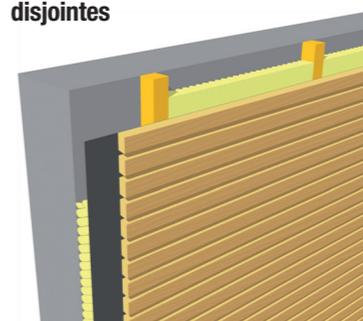
L'absorption acoustique des moyennes et hautes fréquences peut également être réalisée au moyen de lames de bois disjointes, posées sur un feutre ou un isolant, ce qui donne la possibilité d'associer correction acoustique et résistance mécanique aux chocs (ballons).
