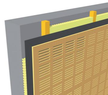
L'absorption acoustique des moyennes et hautes fréquences est réalisée au moyen de panneaux perforés posés sur un isolant. L'absorption sera plus ou moins forte selon la géométrie et la distribution des perforations. Le graphisme créé par ces perforations est étudié de manière à favoriser l'aspect esthétique des panneaux et à éviter une fatigue visuelle.
