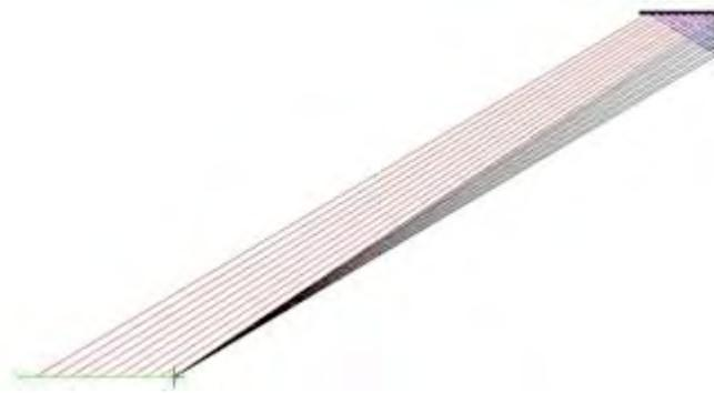
*Simulation acoustique d'un réflecteur d'ordre 2 : les rayons noirs représentent l'onde directe vers la surface verticale (pour plus de clarté, nous n'avons pas représenté le chemin de l'onde vers la surface horizontale), les rayons rouges les ondes réfléchies (après deux réflexions). La ligne verte indique la zone au sol couverte par des réflexions.*
