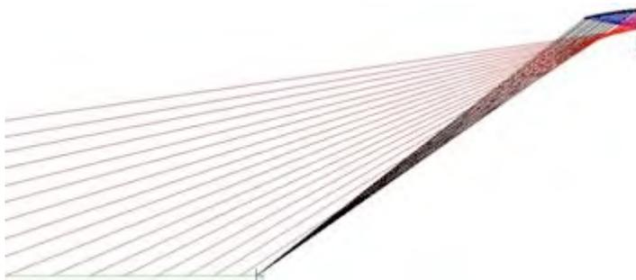
*Simulation acoustique d'un réflecteur d'ordre 2 : les rayons noirs représentent l'onde directe orientée vers la surface verticale courbée, les rayons rouges les ondes réfléchies (après deux réflexions). La ligne verte indique la zone au sol couverte par des réflexions.*
