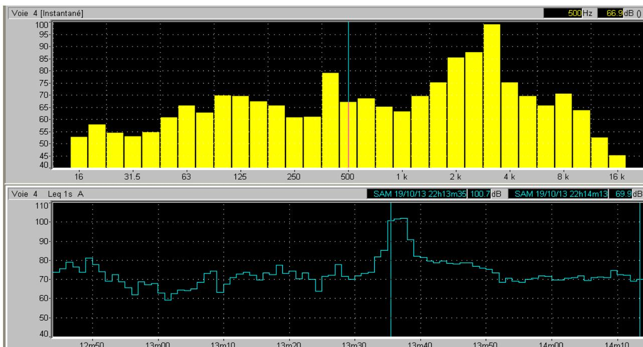
Les autres pics de niveau sonore sont essentiellement dus aux coups de sifflets. Le contenu spectral d'un coup de sifflet est représenté ci-dessous (pics à 800 Hz et 4 kHz).
