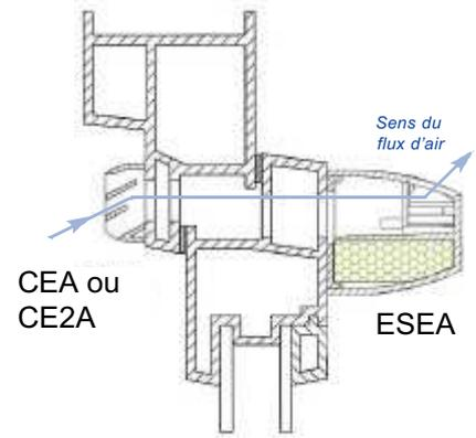
**Attention :** L'entrée d'air ÉSÉA 45 m<sup>3</sup>/h se pose uniquement sur l'entaille 354 x 12 mm.
