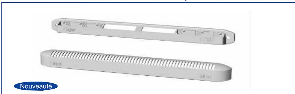
L'entrée d'air autoréglable ajustable **Série VM** débit de base 15 m<sup>3</sup>/h (sous 20 Pascals) installée à l'intérieur du logement est associée à un capuchon ou une grille de façade. Elle est équipée de cales sécables permettant d'obtenir un débit jusqu'à 30 m<sup>3</sup>/h.
