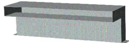
**Manchon tunnel TU :** fixé en partie haute de la menuiserie avant la pose du doublage. Il est associé côté intérieur à une entrée d'air VM et côté extérieur à une grille de façade GPVM.
