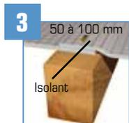
Aux jonctions, réaliser un recouvrement des lés sur 50 à 100 mm. Agrafer le 1<sup>er</sup> lés sur le 2<sup>ème</sup> tous les 50 mm minimum sur ces mêmes supports\*.
