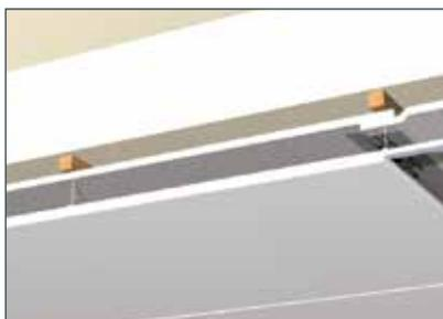
Respecter une lame d'air de 20 mm minimum sur chacune des faces de l'isolant.
