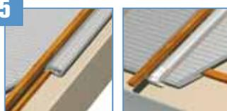
En périphérie de l'isolation, réaliser un retour d'isolant de 50 mm au minimum. Si possible, bloquer l'isolant avec un tasseau.
