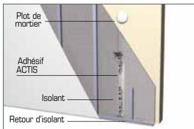
Respecter une lame d'air de 20 mm minimum sur chacune des faces de l'isolant.
