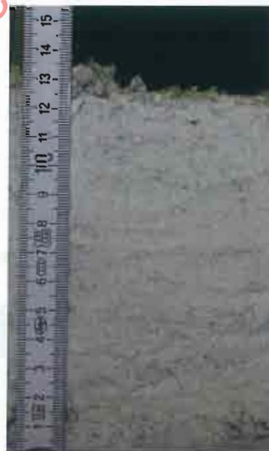
**Figure 4.2** Vue en coupe du procédé de laine projetée ISOTHERM d'environ 130 mm.
