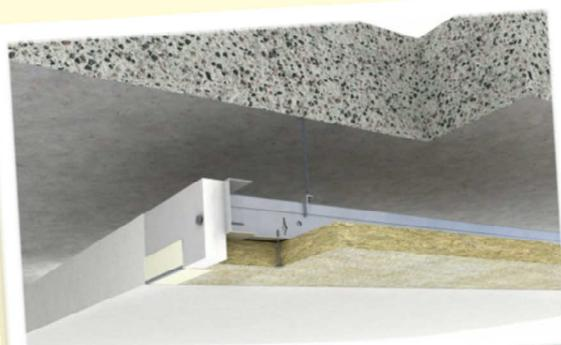
La rive en plaque de plâtre peut recevoir le même enduit de finition que le Mono Acoustic ou peut être peinte.
