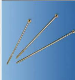
Les vis SuperWood en acier zingué bichromaté sont destinées à fixer le Fibratec ULTRA Réno sur la charpente. Elles sont enfoncées à travers les contre-liteaux (après pré-perçage) ou directement à travers le panneau dans ce cas elles sont munies d'une rondelle de répartition, à raison de minimum 2 pointes par largeur de panneau et par chevron, et pénètrent dans le chevron.
