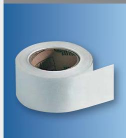
Bande à joint destinée à assurer les jonctions longitudinales et transversales des panneaux de toiture, côté intérieur, en finition plaque de plâtre. La mise en œuvre de cette bande nécessite l'utilisation d'enduit à joint de type EJR en deux passes.
