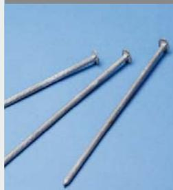
Les pointes Fibratec cannelées crantées en acier galvanisé sont destinées à fixer le Fibratec ULTRA, sur la charpente. Elles sont enfoncées à travers les contre-liteaux (après pré-perçage), à raison de 2 pointes par panneau et par panne, et pénètrent dans la panne. De 210 à 340 mm : pointes de 5,5 mm de Ø. 370 mm : pointes de 7 mm de Ø.
