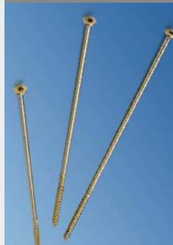
Les vis SuperWood en acier zingué bichromaté sont destinées à fixer le Fibratéc ULTRA Réno sur la charpente. Elles sont enfoncées à travers les contre-liteaux (après pré-perçage) ou directement à travers le panneau dans ce cas elles sont munies d'une rondelle de répartition, à raison de minimum 2 pointes par largeur de panneau et par chevron, et pénètrent dans le chevron.
