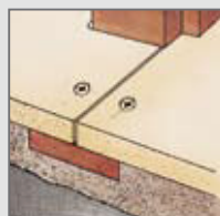
Fig. 8 - Passage de porte chape sèche nu
