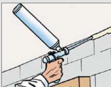
Fig. 4 - Application d'un cordon de mousse expansive sur la cueillie plafond/mur
