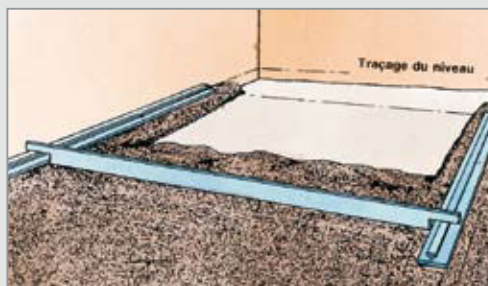
Fig. 1 - Traçage des niveaux et mise en œuvre de la couche d'égalisation
