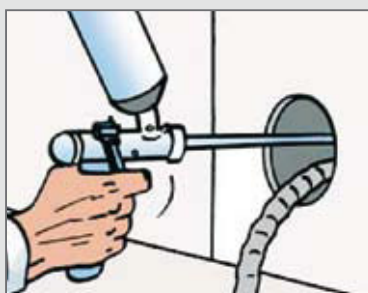
Fig. 8 - Calfeutrer les sorties des gaines électriques
