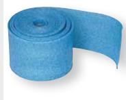
Bande en mousse de polyéthylène extrudé destinée à désolidariser les chapes flottantes, mortier de scellement, chapes sèches des parois verticales, des pieds d'huissierie, seuils et de toute émergence.
