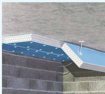
Fig. 21 : Découpe du panneau pour passage des canalisations ou gaines électriques
