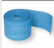
Bande en mousse de polyéthylène extrudé destinée à désolidariser les chapes flottantes, mortier de scellement, chapes sèches des parois verticales, des pieds d' huisserie, seuils et de toute émergence.
