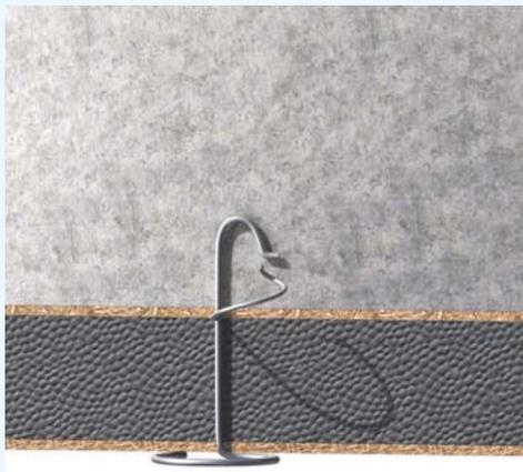
Fig. 6 : Agrafe métallique à relever
