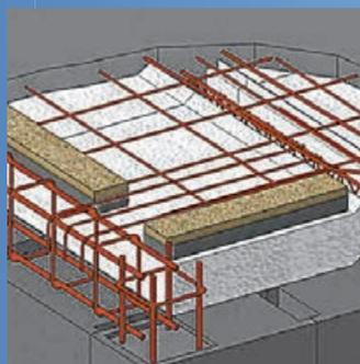
Knauf Hourdiverse<sup>®</sup> G + Rupteur Knauf Stop Therm F15
