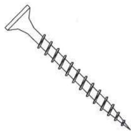
Fig. 5 Accessoire de fixation sur ossature métallique
