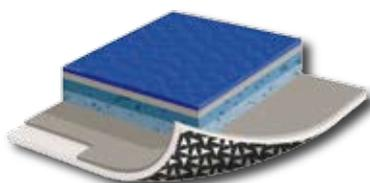
Taraflex® Sporisol est une sous-couche de désolidarisation en PVC d'une épaisseur de 1,5 mm, double face sur voile de verre avec décor en envers constitué de plots de mousse en étoile 3 branches.
