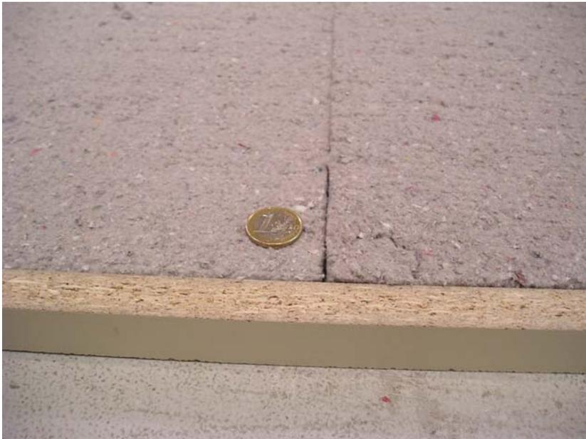
Abbildung 4: 50 mm HOMATHERM Zellulose-Dämmplatten
