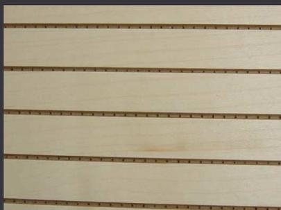
La membrane QUATRO de 6mm d'épaisseur constitue la partie visible d'une solide structure de matériaux d'une couche totale de 31mm. L'énergie acoustique est absorbée par la couche médiane, un résistant panneau de fibres de 22mm d'épaisseur.
