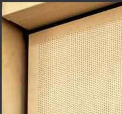
Le revêtement RONDO est caractérisé par de microscopiques petits trous par m<sup>2</sup>, ceci constitue la partie visible d'un panneau acoustique de 19mm d'épaisseur pour murs et plafonds. Les couches médianes d'une plaque perforée HDF, fibres acoustiques comprises, procurent au panneau une excellente acoustique et la résistance nécessaire.
