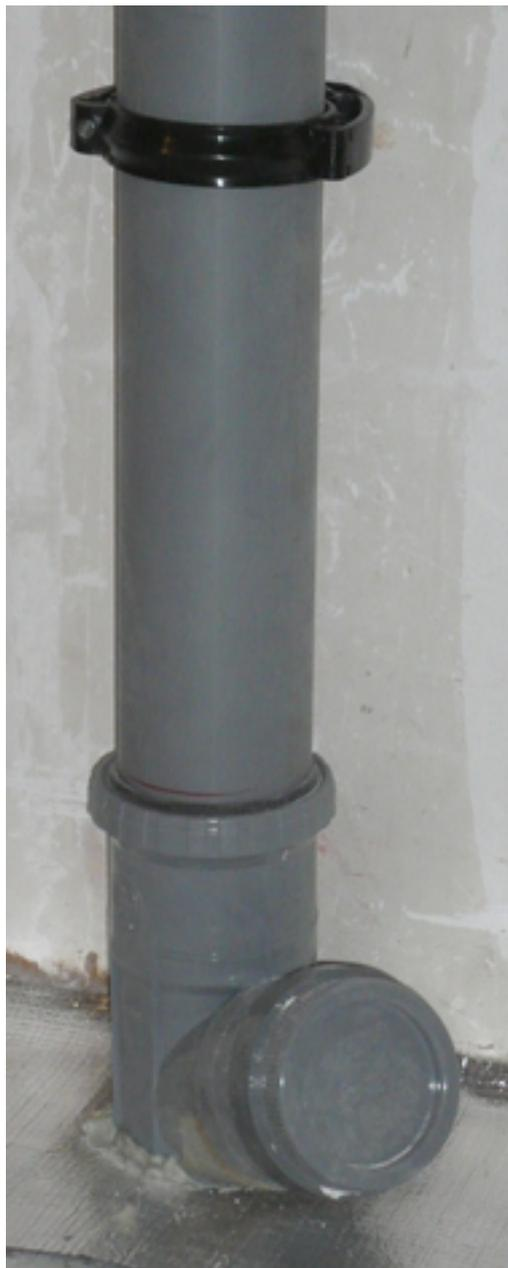
Bride acoustique en partie haute de la conduite dans le laboratoire de mesure.
