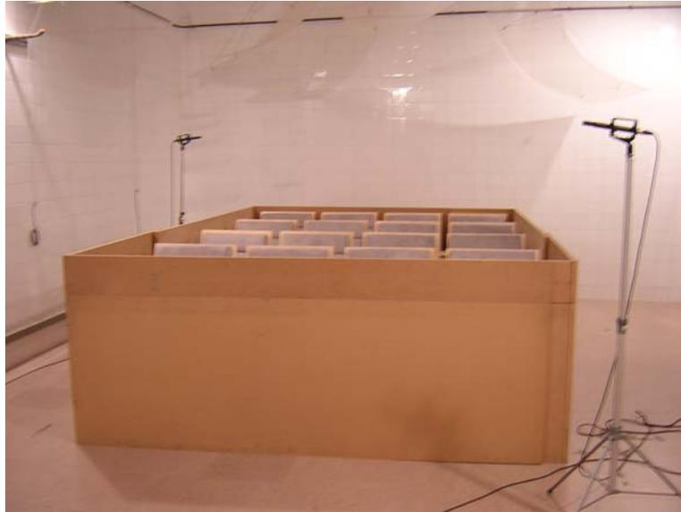
Figura 2. Vista de la càmera reverberante con el montaje de las butacas en el centro de la sala rodeadas perimetralmente para evitar la absorción lateral.
